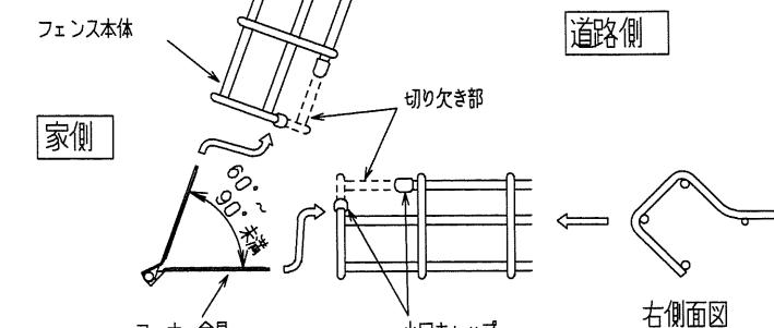
コーナーを鋭角（出隅は60°～70°未満、入隅は60°～90°未満）に納める時は、図の様にフェンス本体を切り欠き、切断面に修復ペイントを塗り乾燥後、小口キャップを取り付けて納めます。
