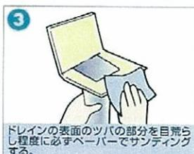
ドレインの表面のツバの部分を目荒し程度に必ずペーパーでサンディングする。
