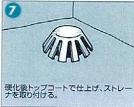
硬化後トップコートで仕上げ、ストレーナを取り付ける。
