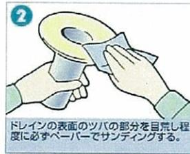
ドレインの表面のツバの部分を目荒し程度に必ずペーパーでサンディングする。
